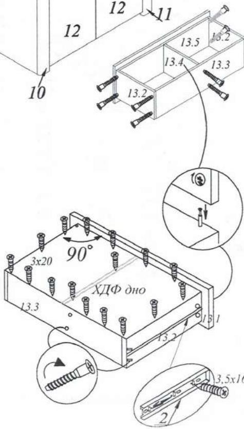
Нажать деблокировочный рычаг для снятия части 2, закрепить ее на блок ящика по наклейкам для регулировочного отверстия, затем зафиксировать направляющие шурупами 4x13 в круглые отверстия
